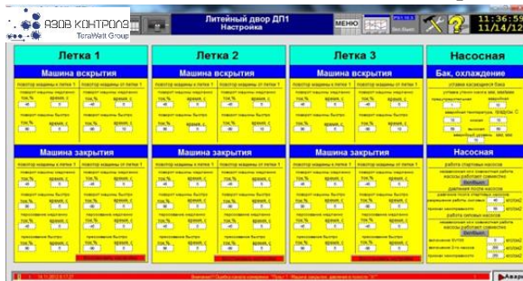
Рис. 5 Экран настроек механизмов литейного двора
